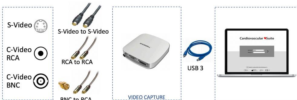
Dettaglio sulle connessioni in base al tipo di uscita video:
